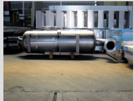
Silenziatori per condotti gas di scarico navi militari e da crociera.
